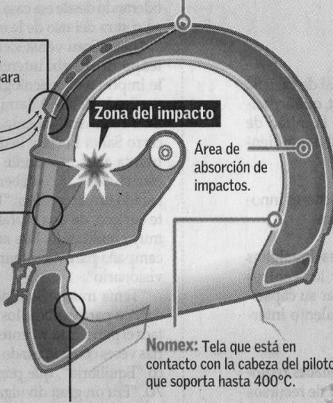
**Diseño personalizado** que se acopla a la línea aerodinámica del coche y a la cabeza del piloto.
